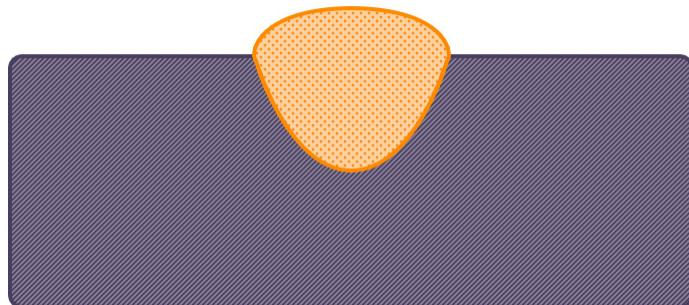
При максимальной индуктивности температура дуги выше, сварочная ванна жидкая, глубина проплавления – максимальная. Валик шва ровный, без выпукростей.
