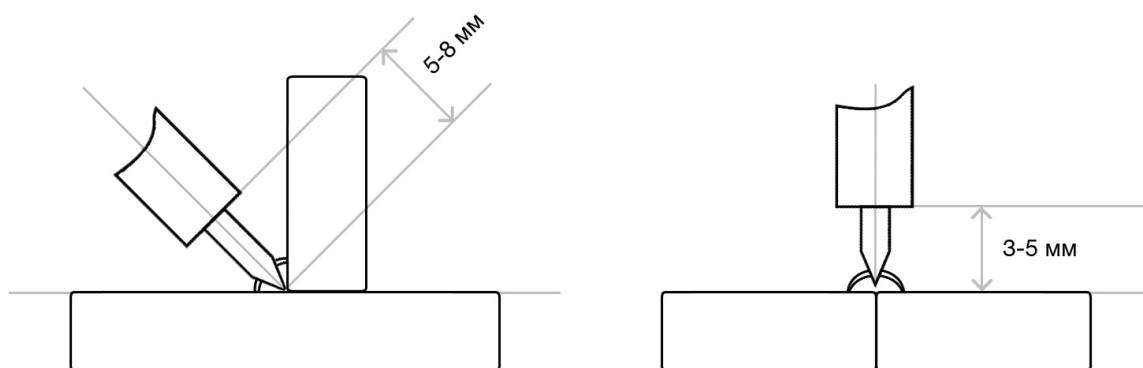
При аргонодуговой сварке также следует не забывать про противоположный угол наклона горелки — это влияет на формирование сварочного шва. Страйтесь держать горелку под углом 90° (по отношению к линии шва).
